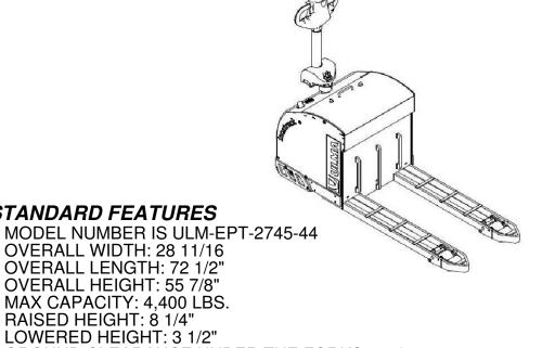
LOWERED HEIGHT: 3 1/2" GROUND CLEARANCE UNDER THE FORKS: 1 1/8"
